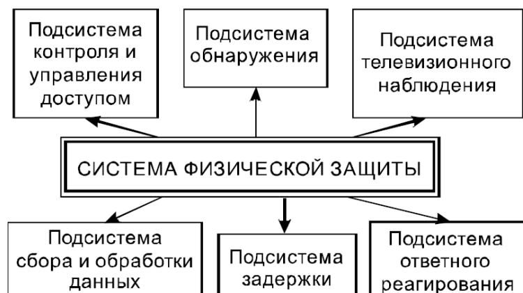
Рис. 1. Структура системы физической защиты
